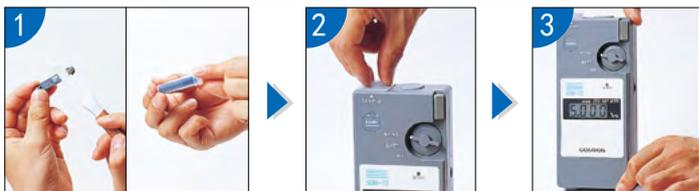
1 用取样勺采取润滑脂并装入试样管内，去除多余的润滑脂。
