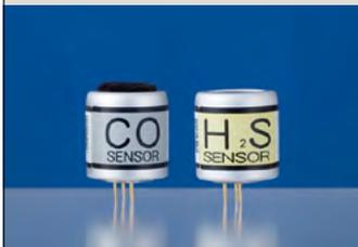
在特定的电位对气体进行电解, 检测此时产生的电解电流, 然后测定气体浓度。
