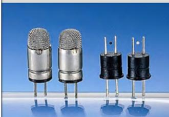
通过对催化剂表面的气体接触燃烧引起铂丝线圈的温度上升 (电阻值变化), 对此变化进行测定。
