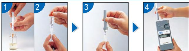
1 将被测油装入试样瓶内，并搅拌、摇匀。在注射器上安装采油嘴后，立即采取试样油。
