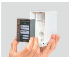
3 拆去旧的传感器单元，更换新的传感器单元。
