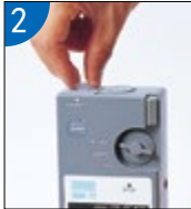
将采取的试样润滑脂插入“SAMPLE”入口。
