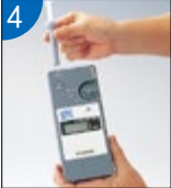
试样插入后，自动检测并显示铁粉浓度。
