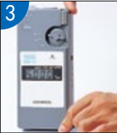
试样插入后，自动检测，并显示铁粉浓度。
