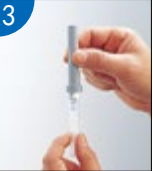
充分摇动注射器，待摇匀试样油后，装入注射器抽座。
